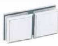
GTS1-05 CONECTOR STICLA 180° MATERIAL: INOX FINISAJ: MAT SAU LUCIOS GROSIME STICLA: 10MM 8€ /BUC
